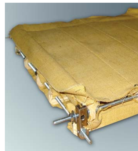
Фото 1. Макет текстопалубки 6000x4000x300 мм
