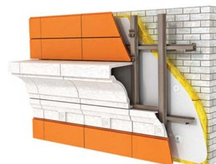
Крепление декоративных элементов из стеклофибробетона на системе «Ронсон»
