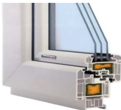
Фото 4. Применение в ПВХ профилях усилителя с заполнением вспененным ПВХ вместо стальных усилителей.
