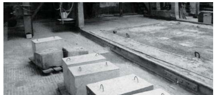
Фото 3. Стеновые блоки из легкого бетона с интегральным расположением крупного заполнителя в цехе завода железобетонных изделий (г. Куйбышев, Новосибирская обл.)
