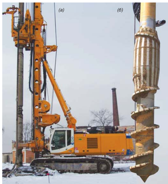
Фото 2. Буровой станок для устройства свай уплотнения (а) и его рабочий орган (б)
